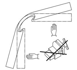
Vor dem Anziehen der Klemmschrauben alle Beschlagteile in Offenstellung bringen. Unterkante Klemmteil der Eckumlenkung bündig mit Kerbe.
