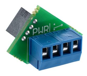
Zur einfachen und zeitsparenden Verdrahtung des Sensors an vorverkabelten Türen
