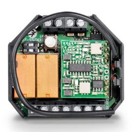
Module récepteur pour la commande de portes automatiques et des entraînements de fenêtre avec 24 V DC
