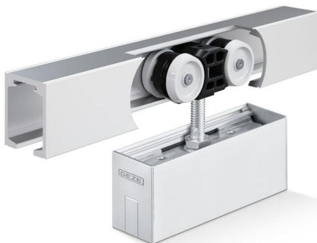
Système de ferrure pour portes coulissantes en verre avec un poids de vantail de 80 kg, une pince de serrage pour porte en verre de 30 mm et fixation murale
